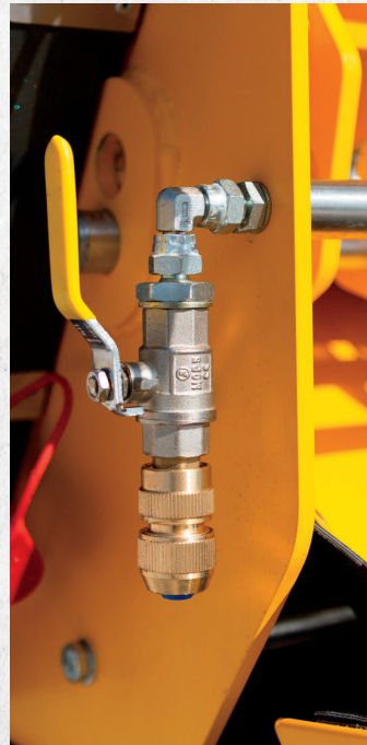
Suppression des poussières
